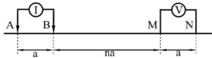
Figura 1-24: Configuración de electrodos en un arreglo dipolo-dipolo (Lascano et al., 2007).
