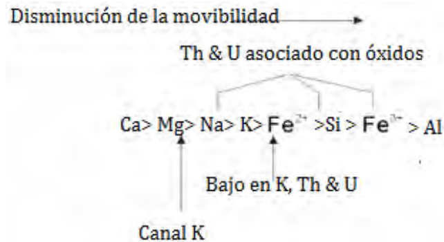
Figura 1-17: Elementos meteorizables y respuesta de rayos gamma (modificado Wilford, 2009).
