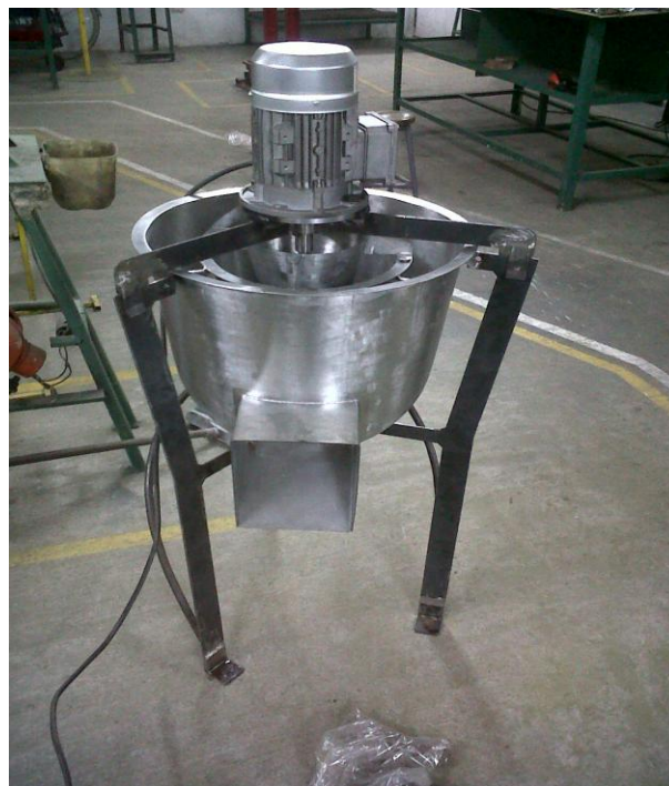
Figura 23-4. Celda de flotación flash, instalada en el IM. CIMEX
