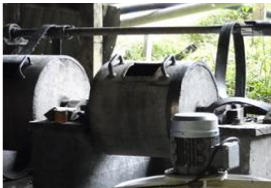
Figura 1-1. “Coco” amalgamador usado en la pequeña minería en Antioquia.
