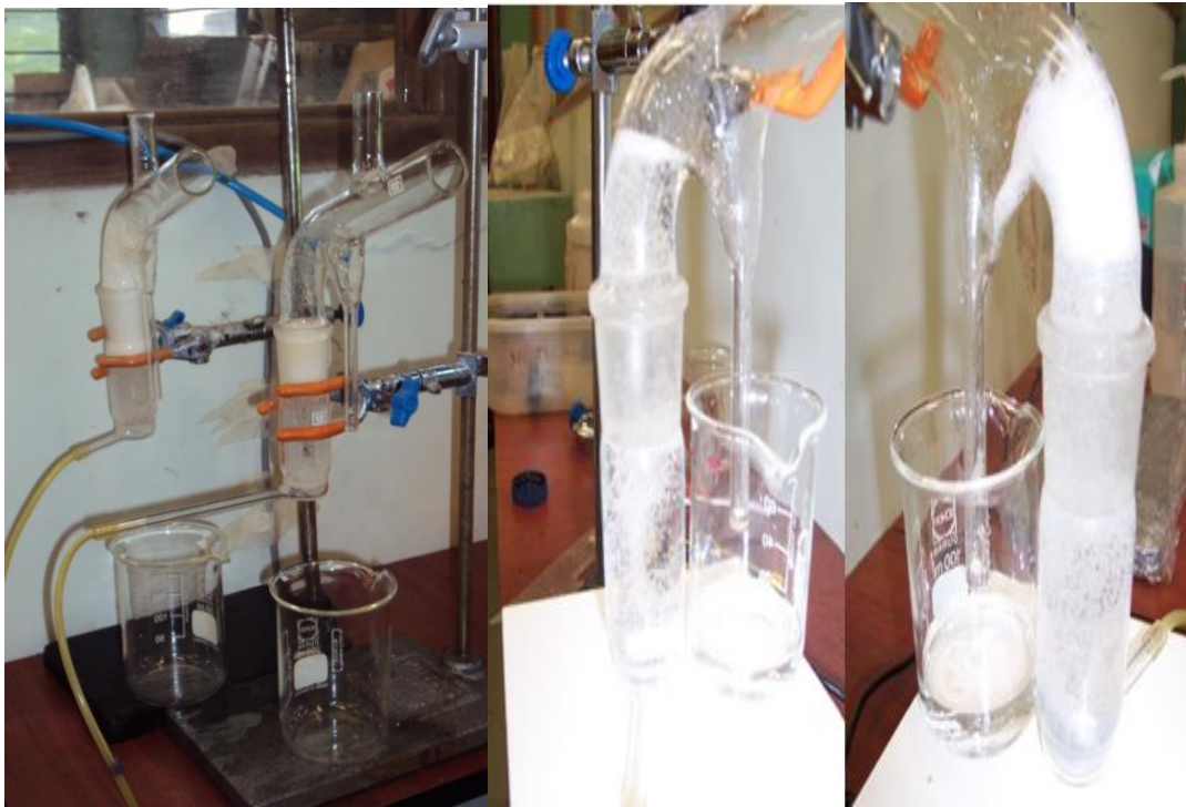
Figura 6.1-3 Microflotaciones en celda Hallimond con partículas de oro. (Foto de montaje en el I.M. CIMEX de la Universidad Nacional)
