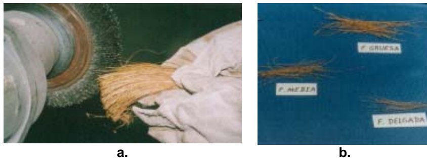
Figura 4. Fibra de la estopa de coco [González & Quintero 2004]: a. Extracción de la fibra; b. Fibra.
