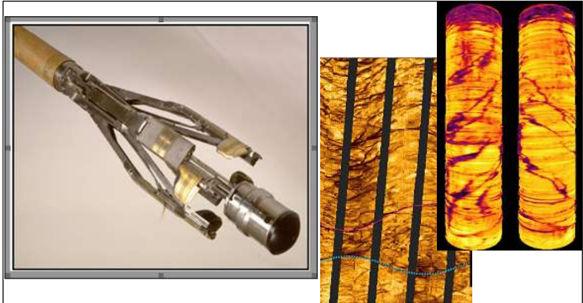
Figura 12. Representación esquemática de la herramienta FMI ( Formation Micro Imager ). Tomado del catalogo de herramientas de registros de Schlumberger, www.slb.com
