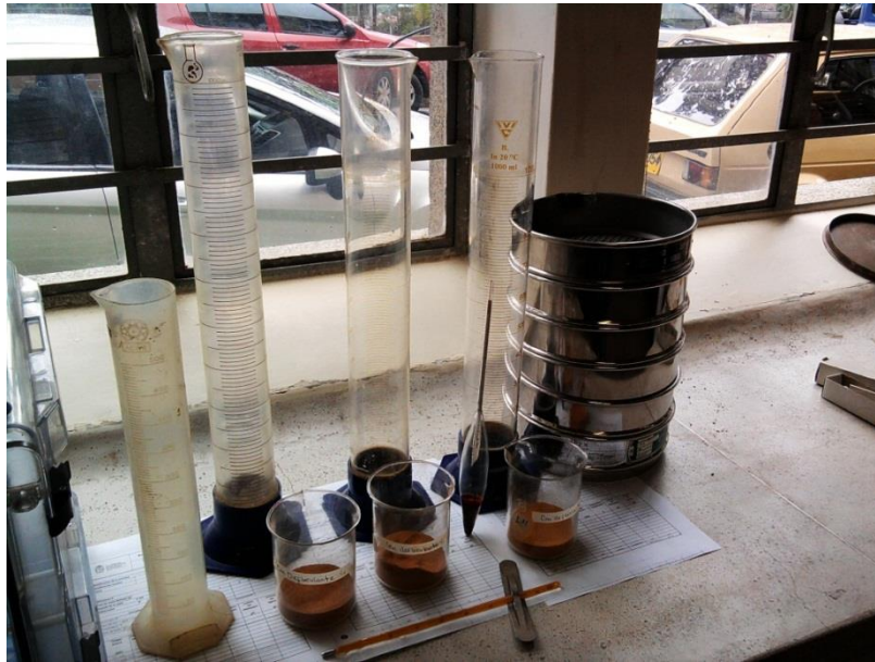
Figura 14. Equipo usado para el Análisis granulométrico.
