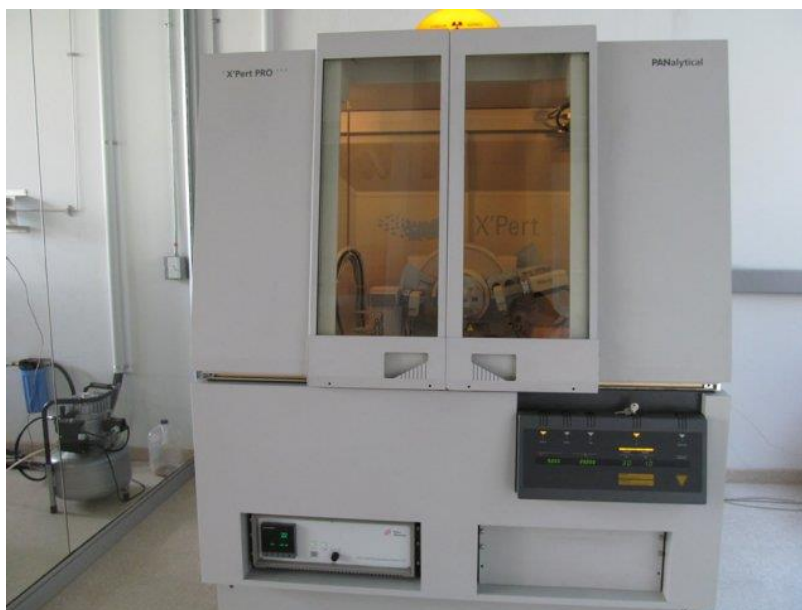
Figura 19. Equipo X'Pert PRO MPD. Laboratorio de caracterización de materiales, Universidad Nacional de Colombia. Facultad de Minas.
