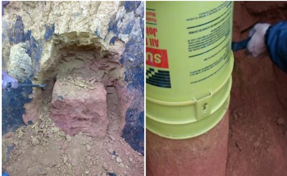
Figura 11. Extracción de muestra inalterada en campo.
