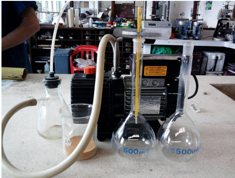
Figura 13. Equipo usado para la prueba de Peso específico de sólidos.
