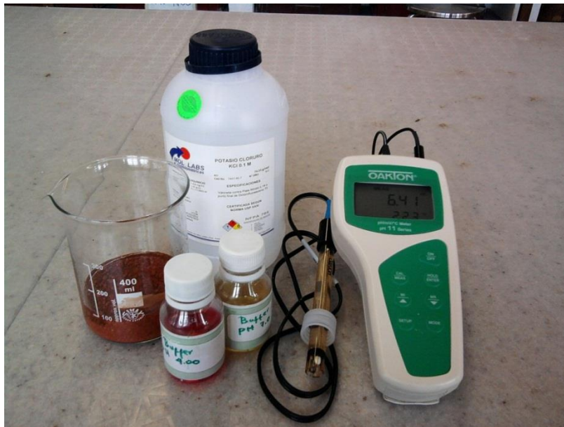
Figura 17. Equipo usado para medir el pH de las muestras de suelo.
