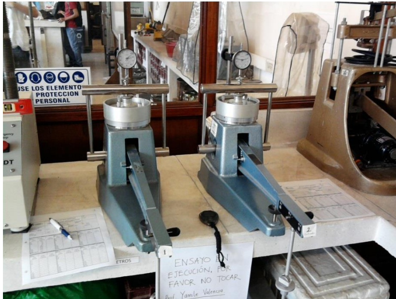
Figura 20. Montaje para la ejecución del ensayo Duploedométrico.
