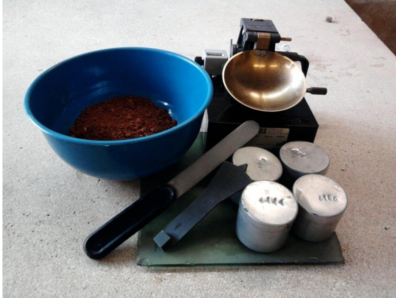
Figura 15. Equipo usado en la determinación de los Límites de Consistencia.
