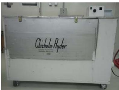
Figura 3-2: Molino de martillos nivel laboratorio
