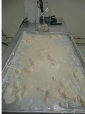
El método de obtención del almidón agrio de ñame se muestra en la figura3-6.
