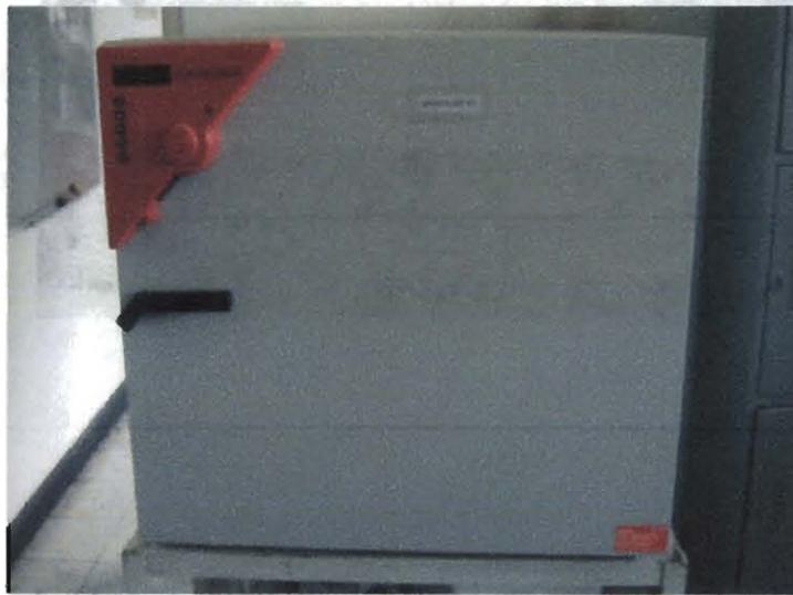
Figura 3.4. Estufa de secado a 105°C.
