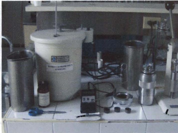
Figura 3.12. Materiales para la determinación de energía bruta.
