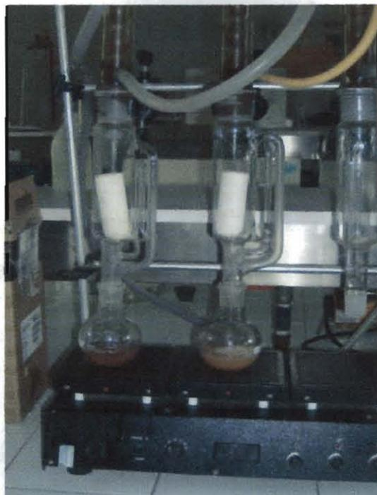
Figura 3.7. Extracción de grasa en equipo Soxhlet.
