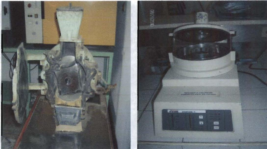
Figura 3.1. A) Molino de martillo, marca Wiley Mile b) Molino de Cuchillas, marca Fritsch
