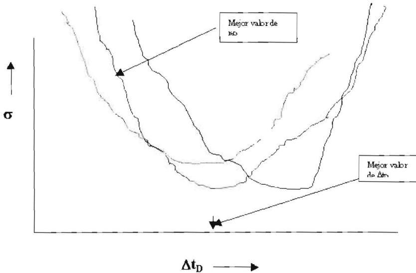
**Figura 13 - Procedimiento de Regresión Lineal Múltiple para Resolver la EBM de un Yacimiento con Empuje Hidráulico.**
