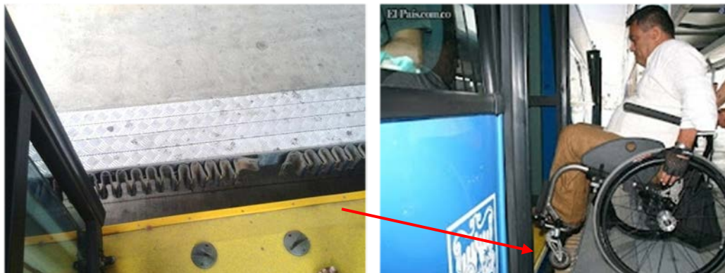
Fig. 3-36. Espacio que se forma entre la plataforma y el vehículo constituye un peligro.
