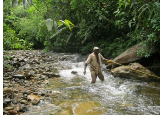
Figura 1-9: Medición de longitud y los anchos de las unidades hidromorfológicas con cinta métrica
