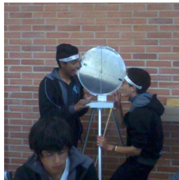
Figura 27. Medidor de ángulos con nonio angular, plomada y trípode
