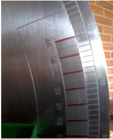
Figura 26. Características del nonio angular para n = 20 divisiones, k = 1 , apreciación de 3' de arco, longitud de 19^\circ y separación de 57'
