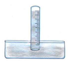
El barómetro de mercurio está formado por un tubo de vidrio cerrado por el extremo superior y abierto por el inferior. El tubo se llena de mercurio, se invierte y se coloca el extremo abierto en un recipiente que también contiene mercurio, la cantidad de mercurio desciendo hasta compensar la presión atmosférica con una columna con una altura de 760mm.
