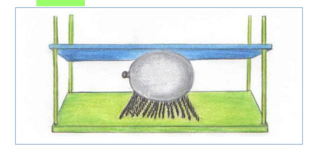
Disponer la bomba inflada en medio de las dos tablas de la cama que solo tiene un clavo. Colocar un libro sobre la tapa superior y observar lo que ocurre con la bomba.
