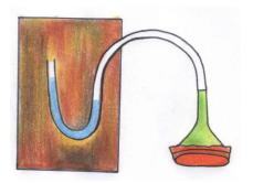
hule hace que la presión al interior del tubo (manguera) aumente. En este caso, la presión del fluido actúa en dirección vertical y sentido hacia arriba.
