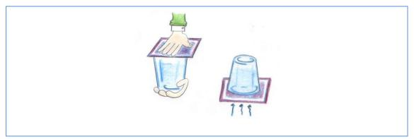
Cuénteles que la presión atmosférica actúa hacia arriba de la lámina impidiendo que el agua se derrame, que si el vaso no fuera sellado la presión actuaría sobre el agua en la parte superior igualando las presiones y el peso del agua caería por su peso.
