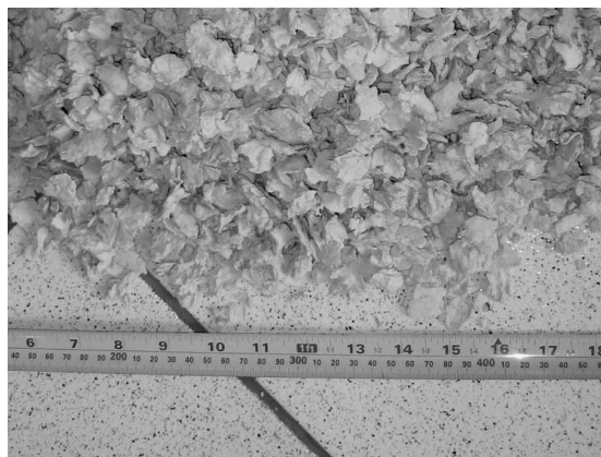
Figura 1. Presentación de la celulosa reciclada utilizada en la fabricación de las muestras
