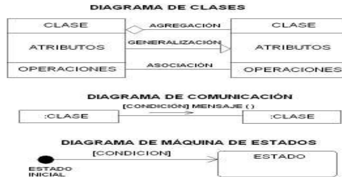
Figura 3. Símbolos de UML 2.0 Figure 3. UML 2.0 Symbols.
