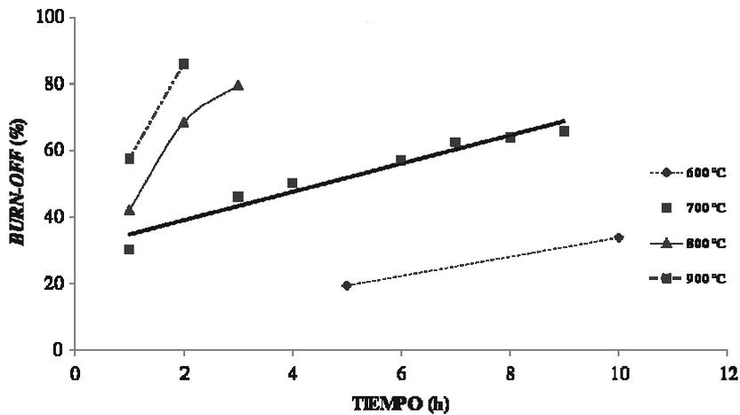
Figura 1. Evolución del *burn-off* en función del tiempo de activación.
