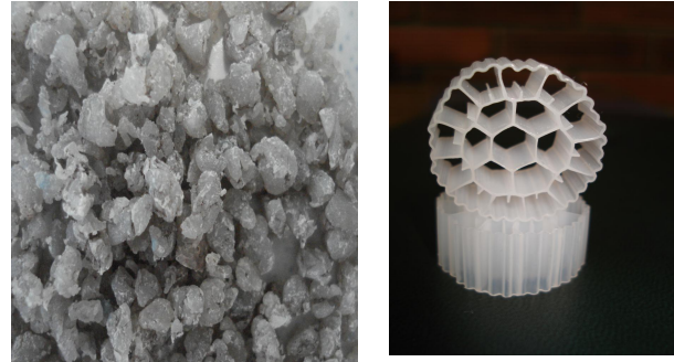
Figura 1. Medios de soporte en reactor Aerobio
