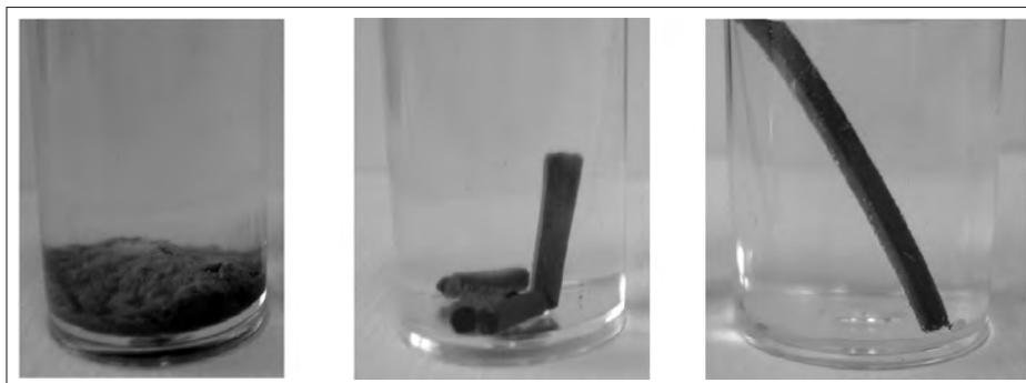
**Figura 3.** Ensayos de estabilidad mecánica de los extruidos de AlFe-PILC en función del tratamiento térmico: a) 105 °C, b) 400 °C y 500 °C.
