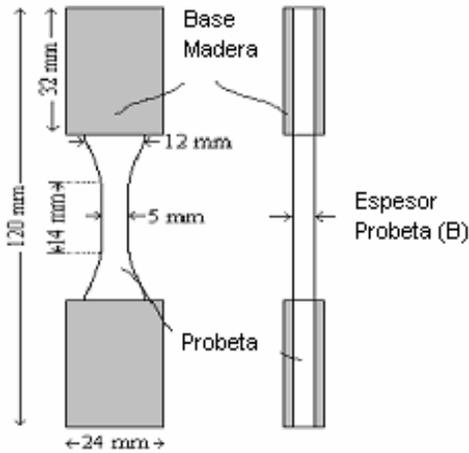
Figura 1. Probetas para realizar en guadua pruebas de tensión paralela a la fibra.
