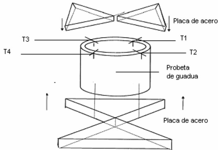
**Figura 2.** Probetas para realizar pruebas de cizalladura en guadua.
