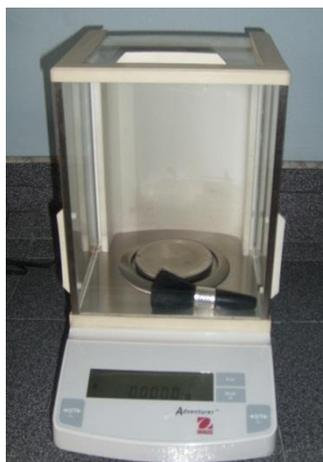
**Figura 3-2:** Balanza empleada en el pesado de los precursores.
