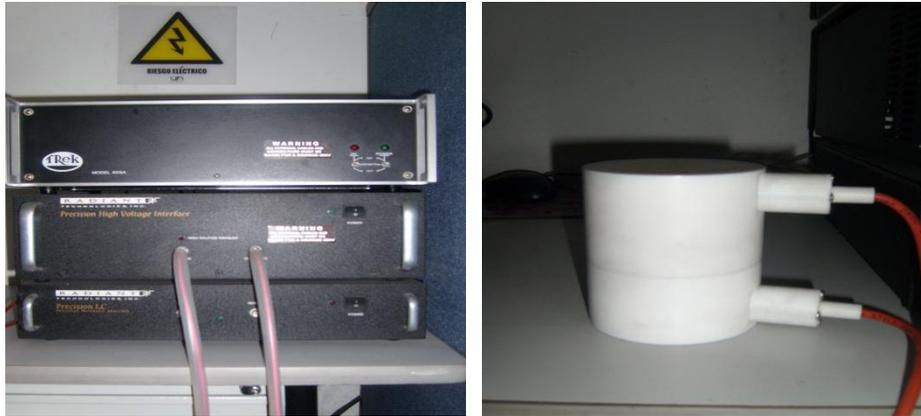
**Figura 4-9:** Polarímetro Radiant Technologies model 609A con su respectiva celda de medición.
