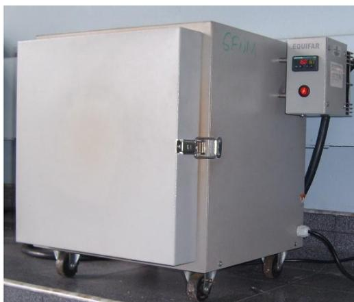
**Figura 3-1:** Horno empleado en el secado de los precursores y el tratamiento térmico hasta  $1150^\circ\text{C}$ .
