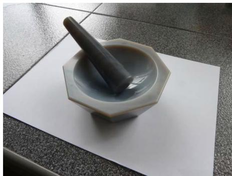
**Figura 3-3:** Mortero de ágata empleado en la mezcla y macerado de los precursores.
