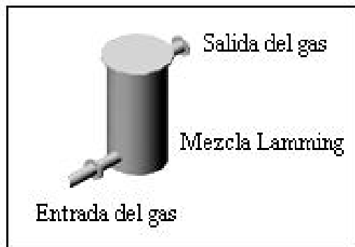
Figura 6 Torre de limpieza química
