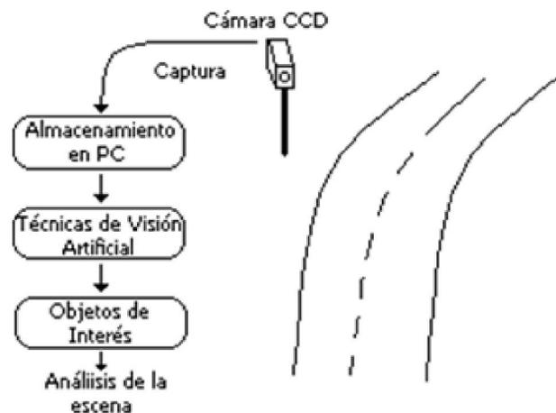
Figura 1. Sistema típico de visión para monitoreo del tránsito<sup>1</sup> vehicular
