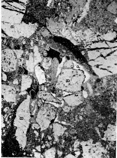
Ejemplo de textura brechada. Alrededor de los fragmentos de blenda (B) se observa una deposición de pirita II (P). Muy escasos los fragmentos de minerales de ganga. Micrografía de sección pulida, luz natural, ampliación 12x.
