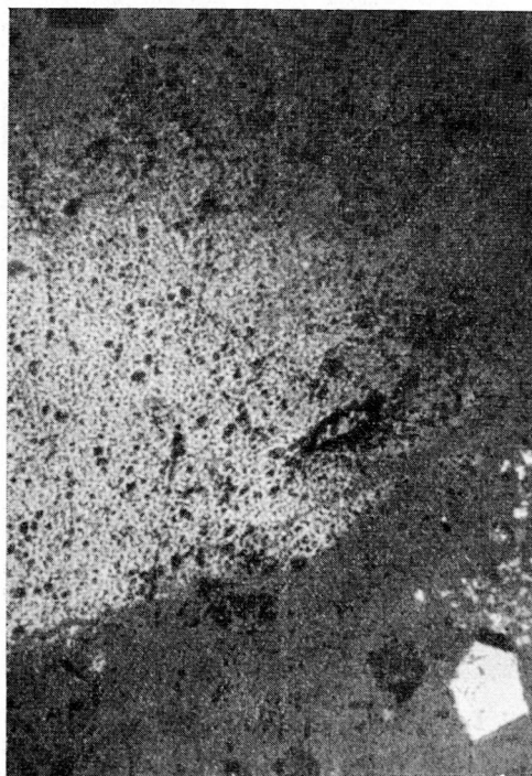
Minerales metálicos del filón San Celestino: pirita II en forma de impregnación muy fina de la roca y pirita I, idiomorfa. Micrografía de sección pulida, sólo polarizador, ampliación 225x.
