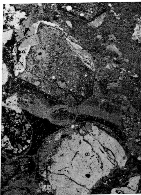
En la izquierda un fragmento de blenda (B) reemplazado en los bordes por cuarzo II (gris). En la derecha, la pirita II (P) se deposita en los bordes de un fragmento de ganga y lo reemplaza en parte. Micrografía de sección pulida, sólo polarizador, ampliación 120x.
