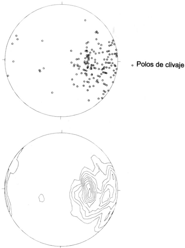
Fig. 13. Compilación de polos de clivaje del bloque colgante de la Falla de San Juanito.
