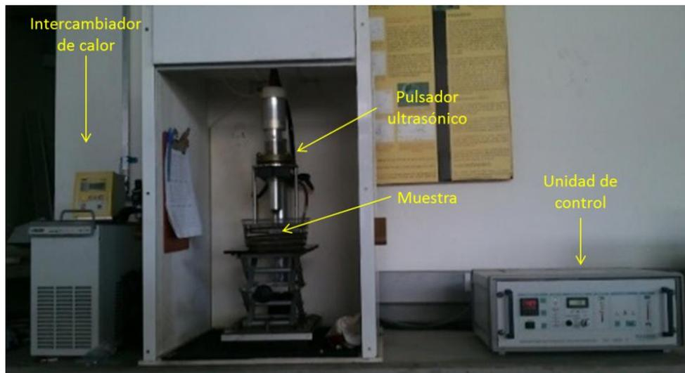
Inicialmente se realizaron pruebas de cavitación sobre muestras que solamente fueron pulidas manualmente con lijas número 240, 320, 400 y 600 sin texturizado; estas pruebas fueron utilizadas como referencia para la resistencia a la cavitación del material base y evaluar así el efecto de la modificación superficial.
