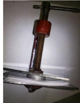
Las muestras fueron sostenidas durante el electropulido con una pinza construida para tal fin, ésta fue hecha con el mismo material de las muestras y solamente tenía expuesta una pequeña punta que garantizaba la conductividad hacia la superficie de la muestra, el área expuesta de la pinza no fue tenida en cuenta al momento de determinar la corriente a utilizar.
