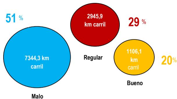
**Figura 1-18:** Estado de la malla vial de Bogotá D. C., Fuente: Base de Datos del Inventario y Diagnóstico de la Malla Vial - IDU - Diciembre de 2011 [32]
