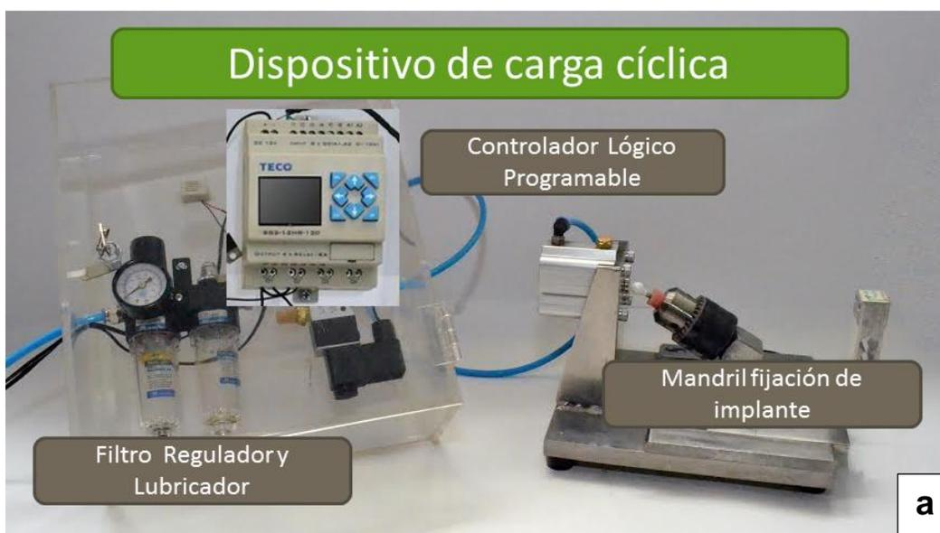
Figura 4-1. a. Dispositivo de carga cíclica señalando los diferentes componentes: PLC, FRL, actuador y mandril de fijación del implante. b. Vista ampliada del dispositivo, señalando el actuador y la celda de control de carga, así como un acercamiento del pistón del actuador con recubrimiento en zirconia.
