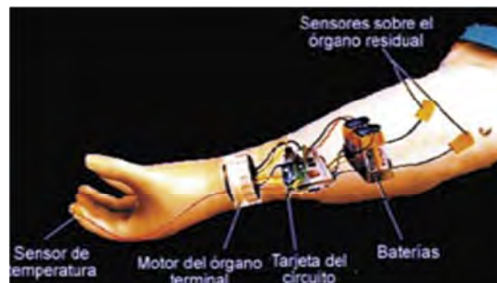
Figura 2.11. Configuración básica de una prótesis mioeléctrica.[7]
