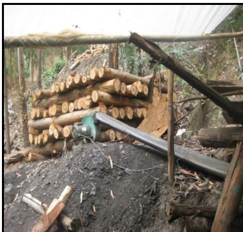
Imagen 15. Sistema de ventilación con ducto de plástico (mina La Fuente)
