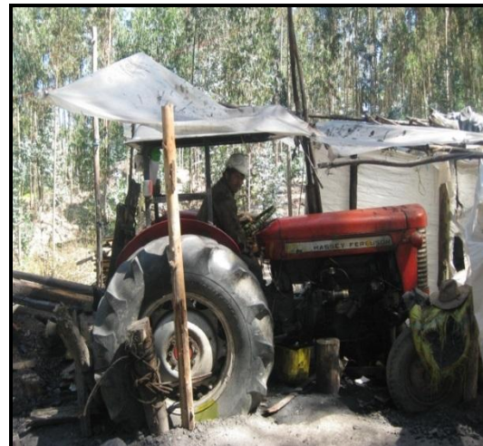
Imagen 13. Malacate de de carbón (mina Tobo 2) Fuente: Autor
