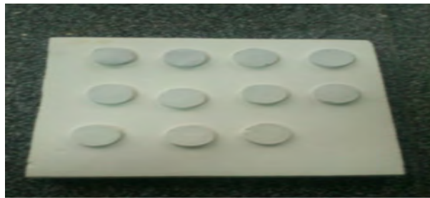
Figura 3-2. Mezclas compactadas variando las concentraciones de caolín y alúmina.
