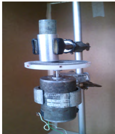
Figura 3-10. Montaje experimental utilizado para realizar la prueba de desgaste por fricción.
