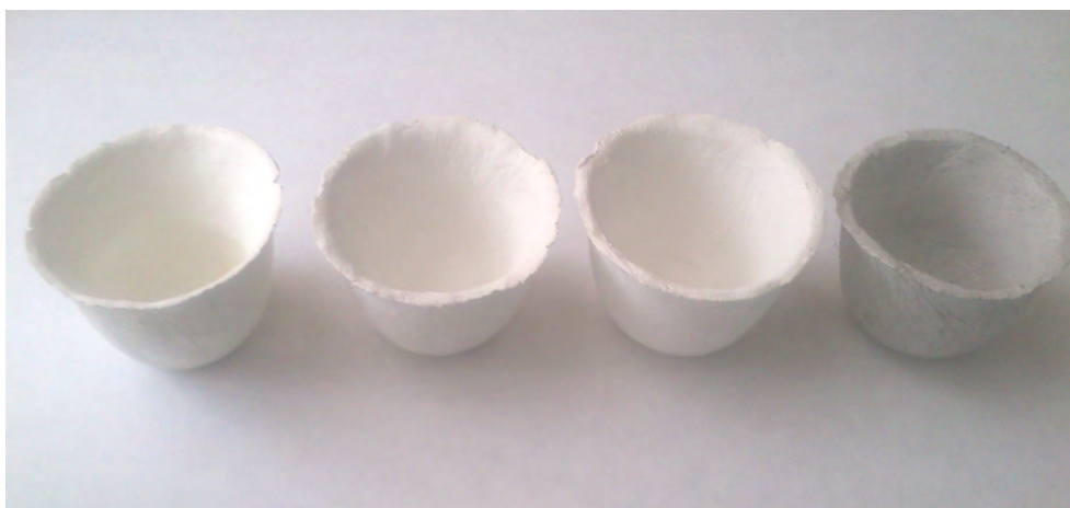
Figura 4-28. Crisoles fabricados a una temperatura de sinterización de 1150°C. De izquierda a derecha crisol con una mezcla de: 100 % caolín, 70 % caolín y 30 % alúmina, 70 % caolín y 30 % alúmina mezclado con 4 % de óxido de magnesio, 70 % caolín y 30 % alúmina mezclado con 4 % de óxido de cobalto.
