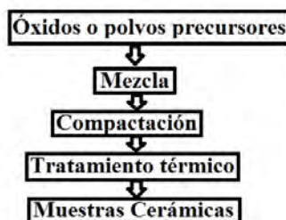
Figura 3-1. Esquema general proceso de síntesis mediante el método de reacción de estado sólido
