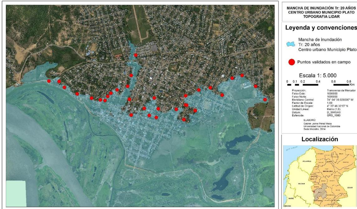
**Figura 60. Validación de la zona de inundación. Puntos rojos son las zonas que se recorrieron para verificar el contorno de la inundación.**
