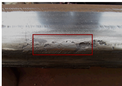
c. Desprendimiento de material (coalescencia de grietas)
