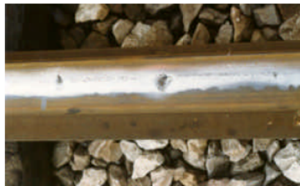
Figura 1-2: Modos de falla en rieles debido a daños en las superficies
