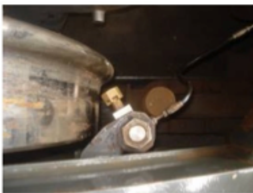
c. Lubricación por medio de lubricador a bordo[29]
