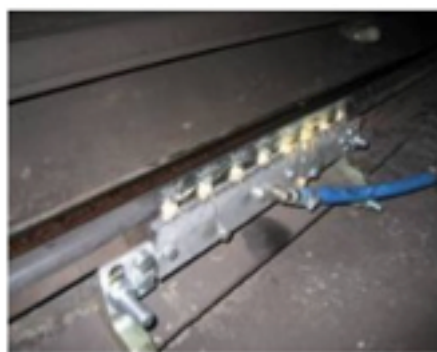
b. Lubricación por medio de lubricador estacionario[31]
