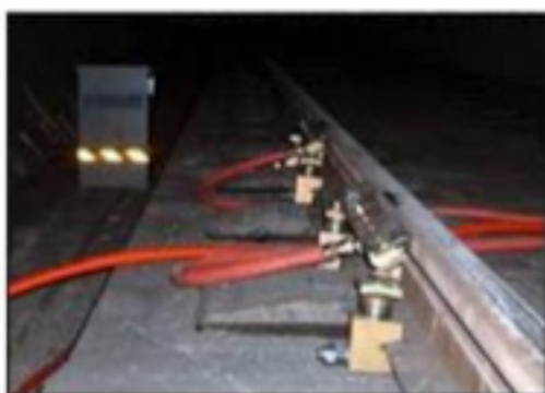
a. Lubricación por medio de lubricador estacionario [30]
