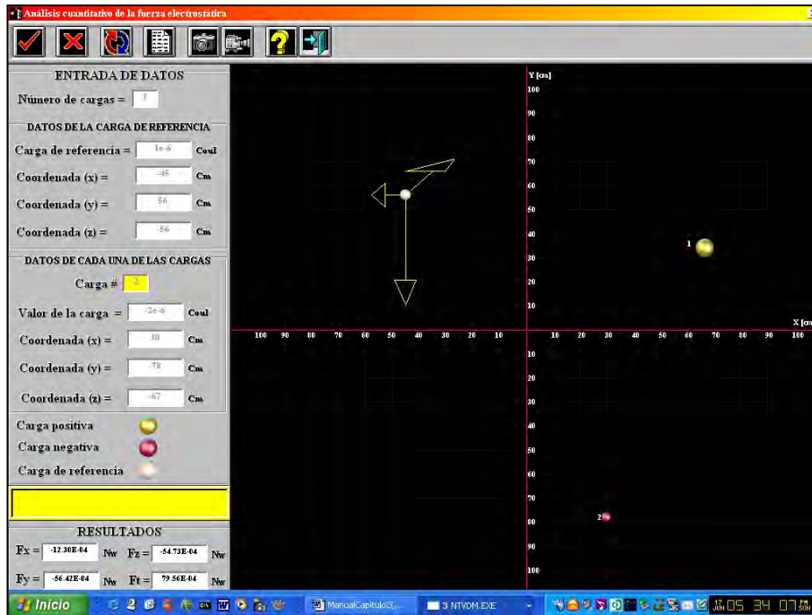
Fig. 2.29 Análisis cuantitativo de la fuerza electrostática sobre la carga de referencia debido a las dos cargas puntuales.
