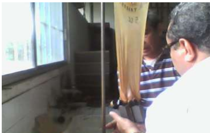
Figura 20. Visualización de la prueba de elasticidad de las láminas de caucho
