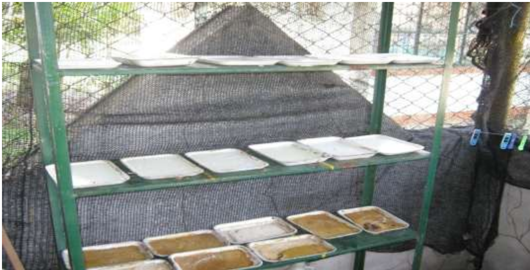
Figura 10. Látex líquido en proceso de coagulación.
