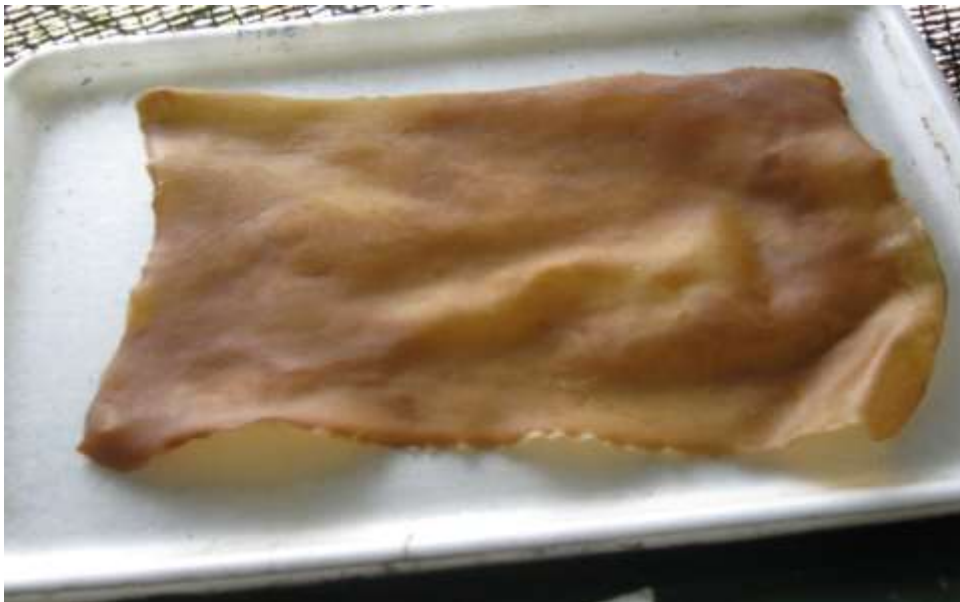
Figura 8. Lámina de caucho seco obtenida con ácido fórmico
