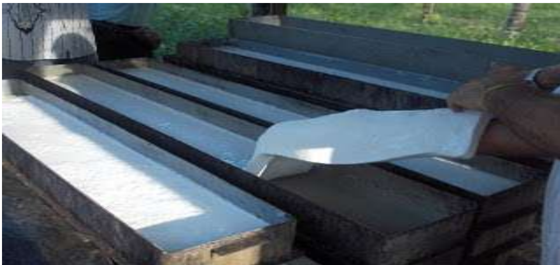
Figura 3. Empleo de Canoas en el proceso de coagulación del látex
