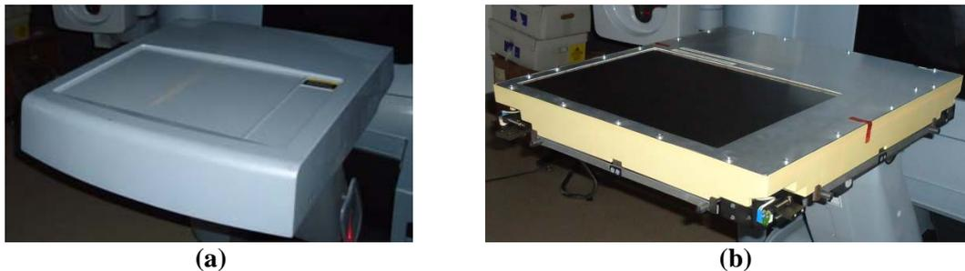
**Figura 6-2** (a) Fotografía del EPID con cubierta plástica protectora. (b) Fotografía del EPID sin cubierta protectora; obsérvese el área activa del detector.
