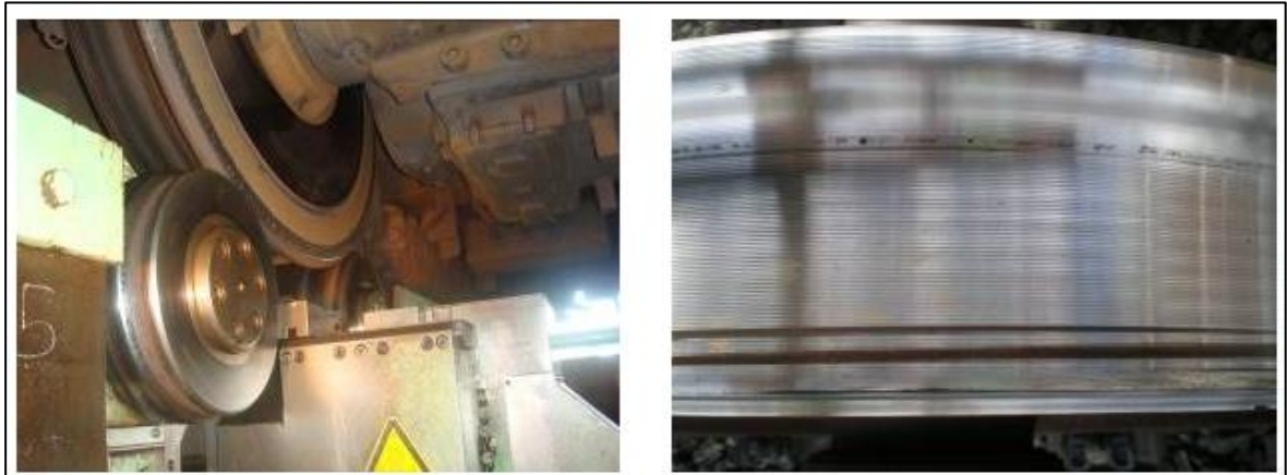
Figura 3-5: Proceso de reperfilado de una rueda del Sistema Metro de Medellín
