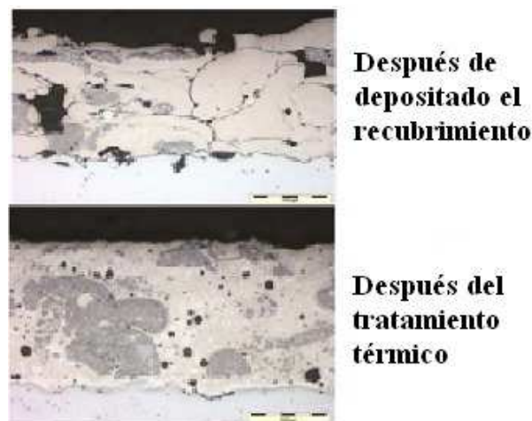
Figura 1-12: Recubrimiento antes y después de un tratamiento térmico [31].
