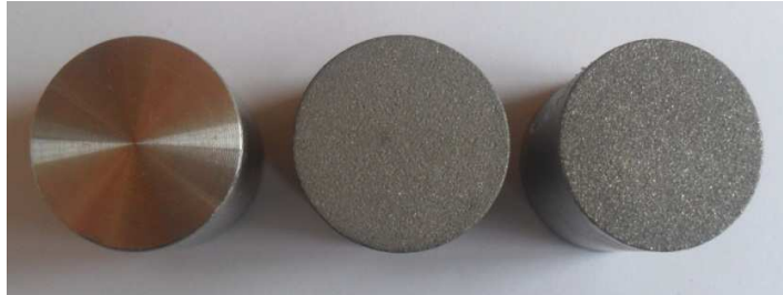
Figura 2-1: Substrato sin preparación y substratos modificados superficialmente
