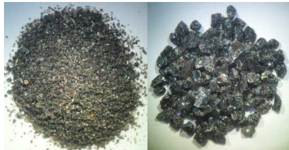
Figura 2-2: Granalla fina y granalla gruesa empleadas para la modificación de la rugosidad superficial de los substratos
