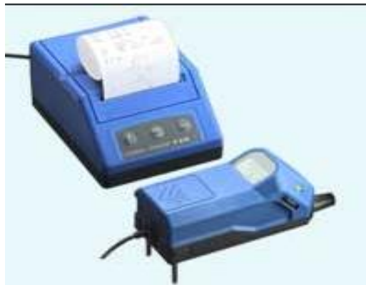
Figura 3.1. Foto rugosímetro Hommel Tesler T 500 [104]
