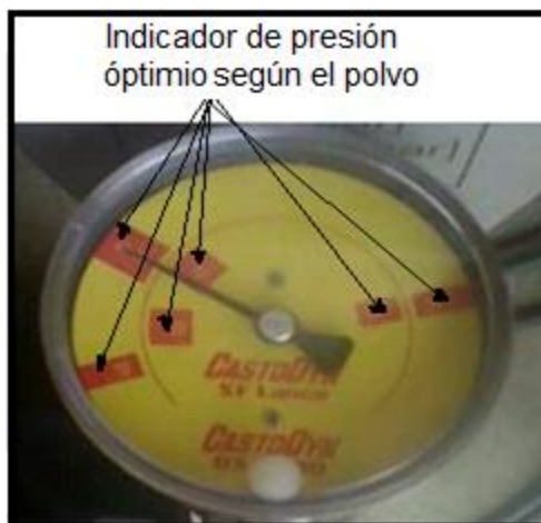
Figura 3.3. Calibración presión de succión del material en polvo
