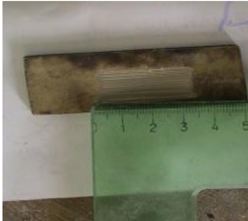
Figura 3.8. Foto de la medición de la huella de desgaste abrasivo a tres cuerpos
