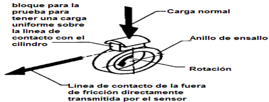
Figura 1.6. Esquema del ensayo según la norma G77 [29]
