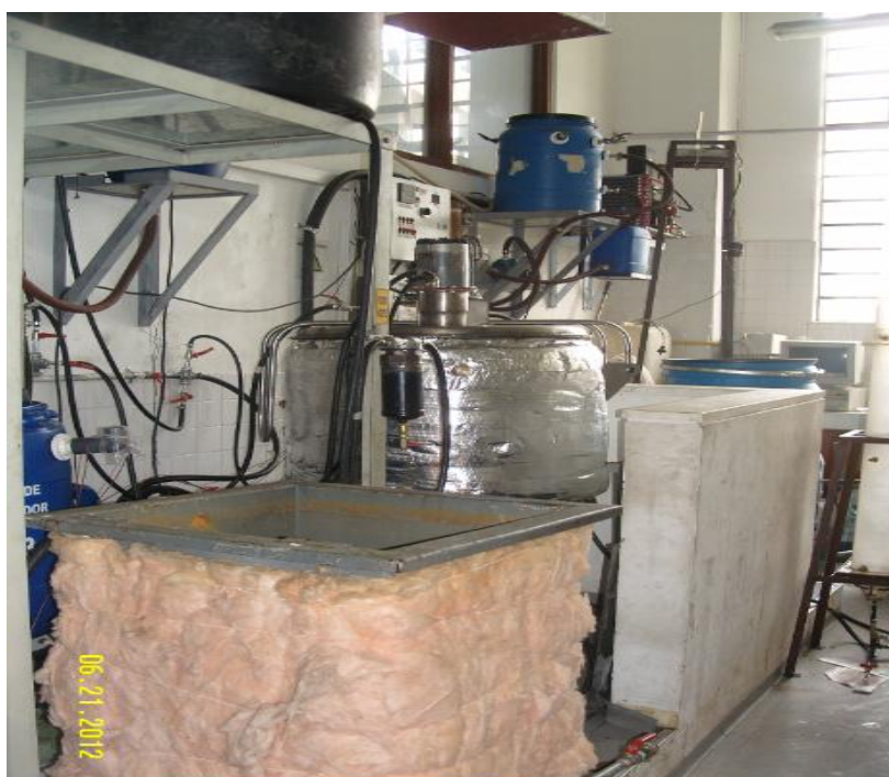
Figura 4-14: Montaje de planta de biodiesel de 150 L/Lote en el edificio de Química de la Universidad Nacional de Colombia. Sede Bogotá.
