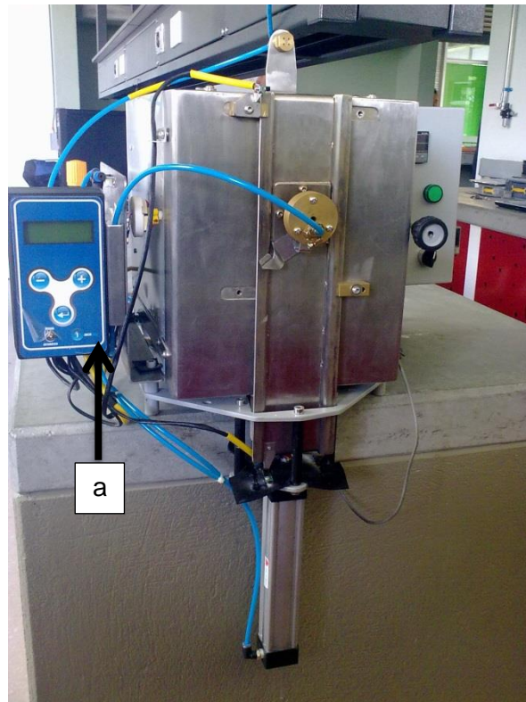
Figura 77. Equipo para ciclos térmicos. a) Panel de control
