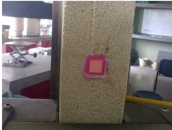
Figura 40. Probeta a alta temperatura justo antes de pasar el ciclo de enfriamiento.
