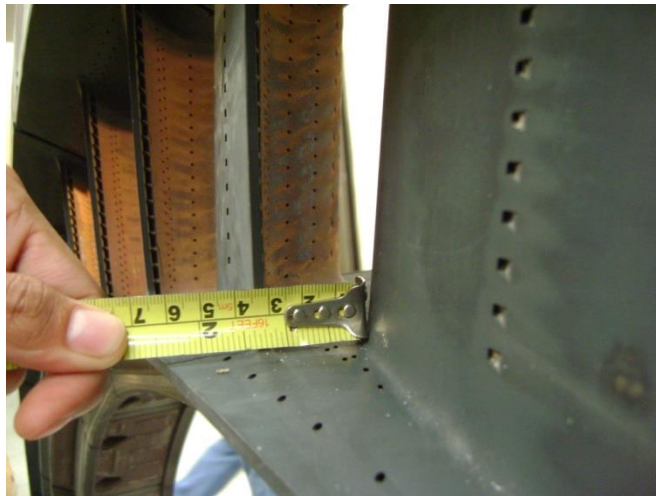
Figura 79. Orificios de refrigeración para juego de álabes un una turbina a gas
