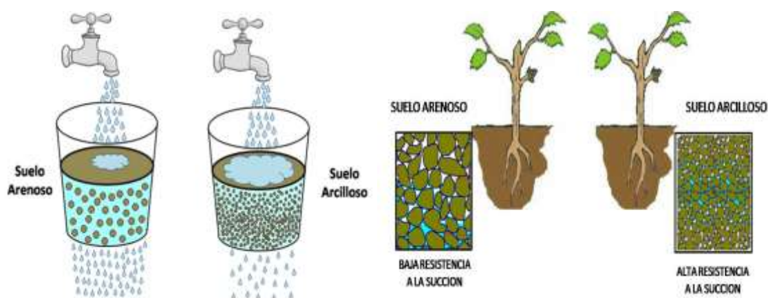
Figura 8.1. Retención de agua en suelo arenoso y suelo arcilloso. Adaptada de: Comisión Nacional de Riego, Gobierno de Chile.
