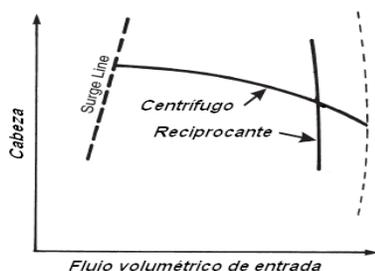
**Figura 1-4.** Representación de la curva característica de un compresor centrífugo y un compresor reciprocante.
