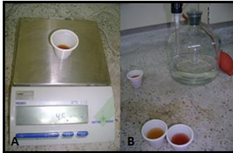
Fotografía 2-14. Prueba de determinación de la acidez total titulable. (ATT)
