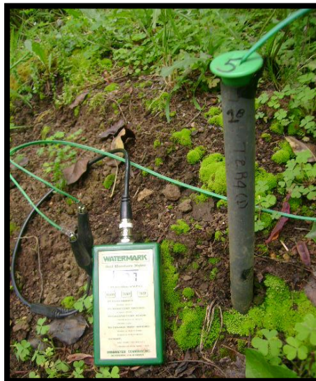
Fotografía 2-5. Medidor Watermark y sensor de matriz granular (Watermark Mod. 200ss Irrrometer Co.)
