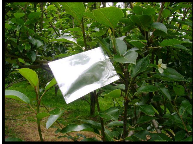
Fotografía 2-7. Hoja cubierta para medición del potencial al tallo ( \Psi_t ).
