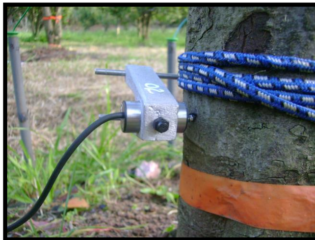
Fotografía 2-9. Dendrómetro (LVDT), instalado en el tronco de Pero variedad “Triunfo de Viena”.
