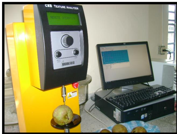
Fotografía 2-13. Medida de firmeza con el analizador de textura de Brookfield Engineering Labs, Inc.
