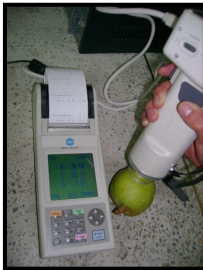
Fotografía 2-12. Determinación del color con Chromameter CR400 Konica Minolta
