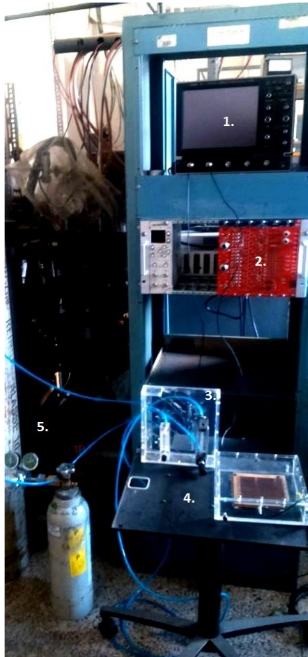
Figura 2.9: Montaje experimental. Se muestra el rack de instrumentos. 1. Osciloscopio. 2. Electrónica estándar NIM. 3. Flujómetros. 4. Soporte para el detector. 5. Sistema de control de flujo de gas, flujómetro DWYER escala: 0.06-0.5 l/min, Flujómetro Vogtlin escala: 0 – 10 N l/h, manómetros y gas de argón y metano.
