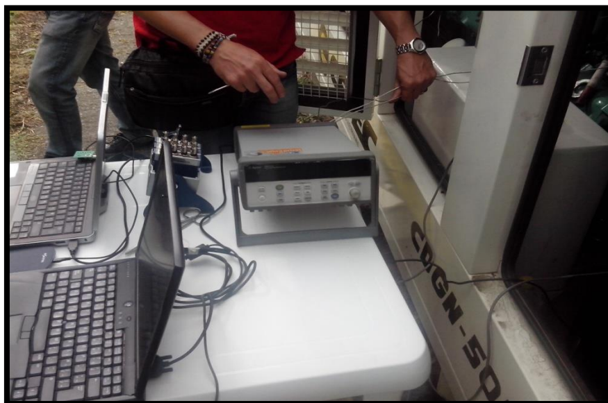
Figura 29: Montaje de sistema de adquisición de datos (National Instruments) Fuente: Ecopetrol – Poligas
