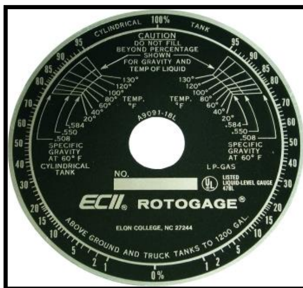
Figura 21: Rotogage de tanque de almacenamiento de GLP Fuente:
