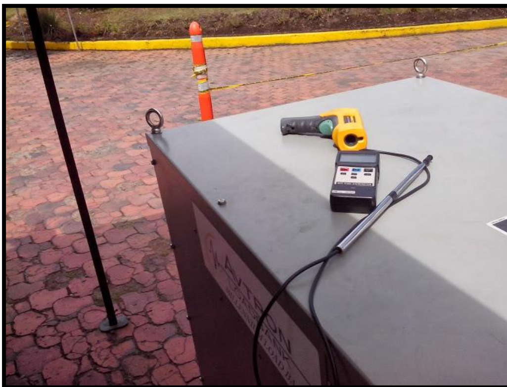
Figura 34: Anemometro de hilo caliente y pirómetro Fuente: Ecopetrol – Poilgas
