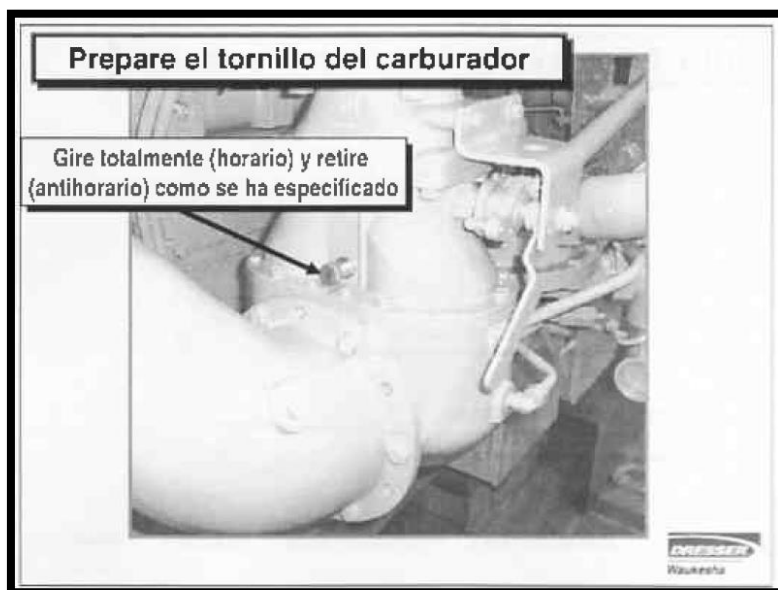
Figura 60: Tornillo de ajuste de flujo másico de combustible de gas en el carburador de motogenerador Waukesha.
