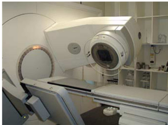
Figura 2-10 Epid de silicio amorfo (a-Si) instalado en el gantry de un LINAC [44].
