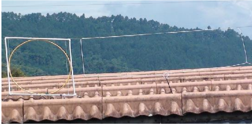
Fig. 7.36: Foto Antenas Lazo mono-espira para conexión a Sensor campo H.
