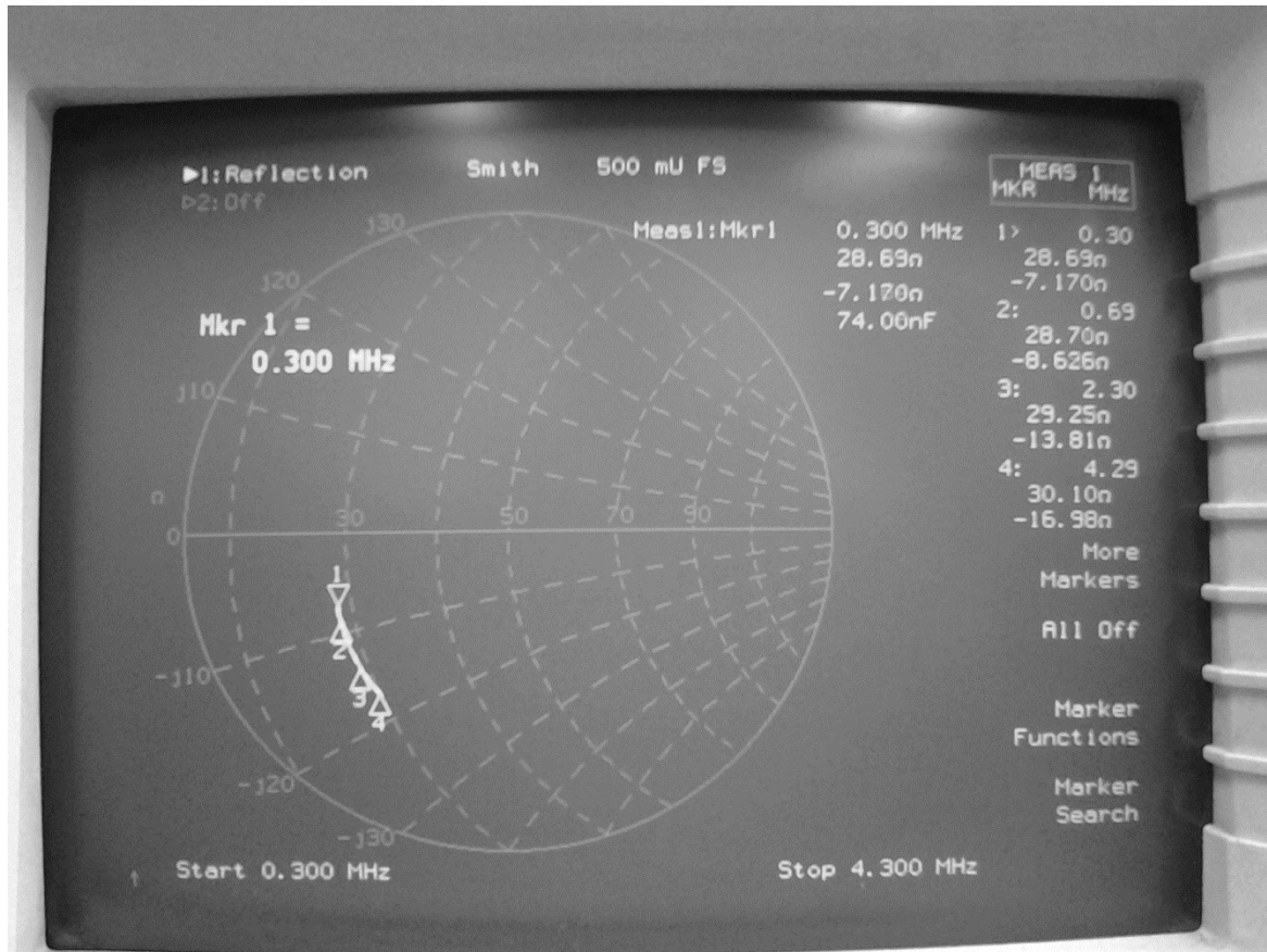
Fig. E.2: Carta de Smith Antena Lazo cuadrada de 12 (medida en malla)
