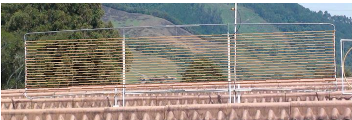
Fig. E.22: Foto Antena Parrilla ubicada en techo edificio Campus La Nubia
