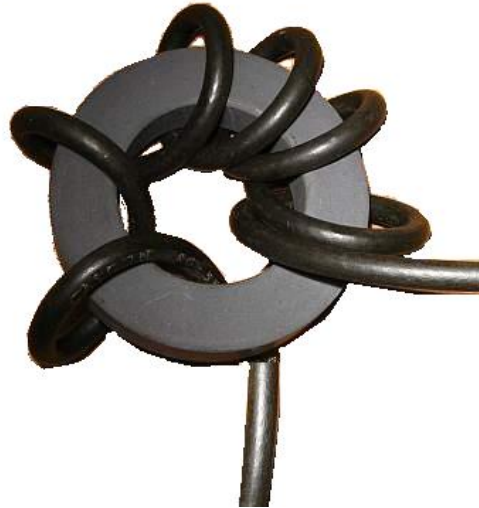
Fig. 7.18: Balun con 7 espiras de cable coaxial alrededor del toroide de ferrita.
