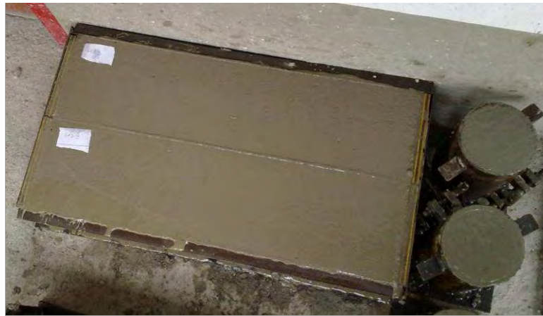
Figura 6-35: Formaleta empleada y proceso de fundidad de las probetas. Ensayo de Flexión
