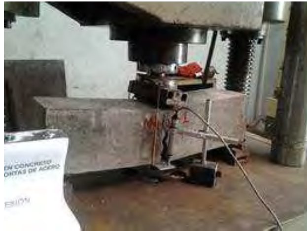
Figura 6-36: Fotografía del ensayo a flexión.
