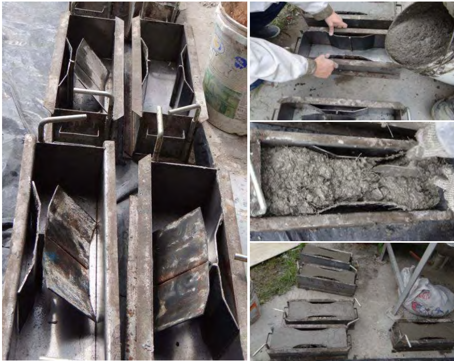
Figura 6-5: Formaleta empleada y proceso de fundición de las probetas
