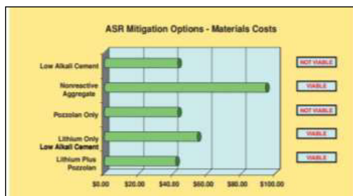
Gráfica No. 6. Mecanismo para controlar la reactividad Álcali Agregado. Fuente (Manissero, FMC Corporation, Lithium Division, & Lithium Technology Manager, 2006).
