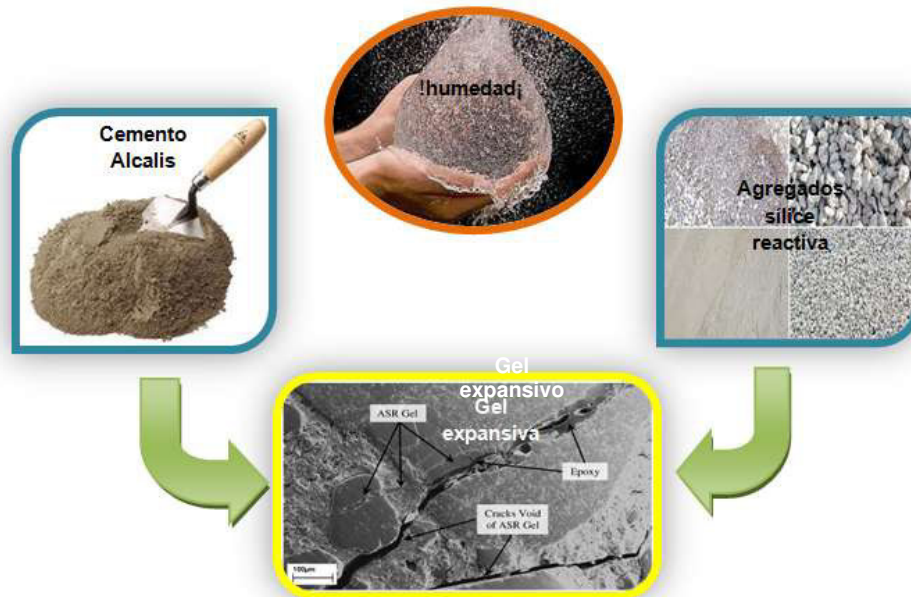
Figura No. 1 Esquema del proceso de RAA.
