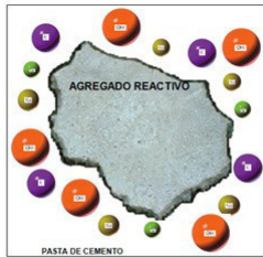
Fase 1 – El agregado reactivo se encuentra dentro de la pasta de cemento con álcalis (Na y K) y radicales OH.
