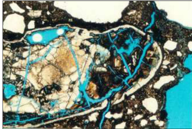
Foto No. 3. Detalle de Agregado opalino agrietado por reactividad álcali-agregado. Fuente: Handbook for identification of alkali-silica reactivity in airfield pavement.
