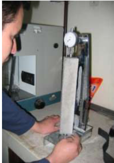
Foto No. 2. Medición de la expansión en el ensayo ASTM 1260. Fuente: Ing. Gabriel Gómez
