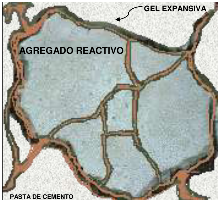
Fase 3 – Aumenta el hinchamiento y empieza la aparición de fisuración en la estructura de concreto a nivel microscópico causada por la presión hidráulica que ocasiona la gel producida al interior del agregado reactivo y la pasta de cemento.
