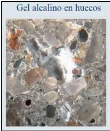
Foto No. 3. Detalle de Agregado opalino agrietado por reactividad álcali-agregado. Fuente: Handbook for identification of alkali-silica reactivity in airfield pavement.
