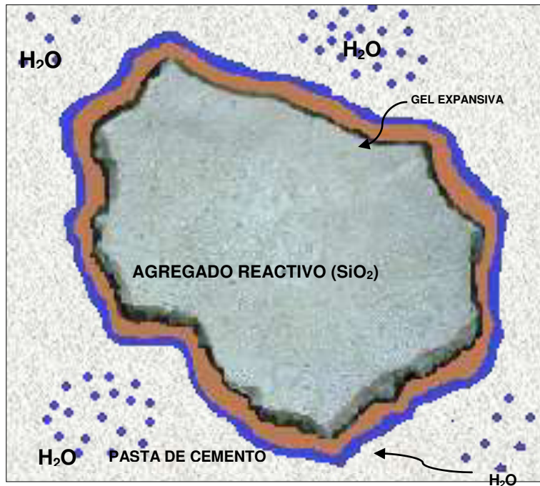
Fase 2 – La presencia de agua activa la Reactividad Álcali Agregado generando la producción de gel expansiva
