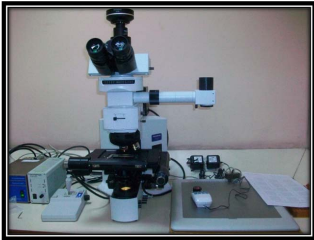
Figura 4. Microscopio adaptado para análisis de trazas de fisión. Laboratorio de Termocronología del Servicio Geológico Colombiano.
