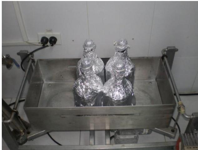
**Ensayo “c”.** Bioreactor con recirculación de la vinaza:
